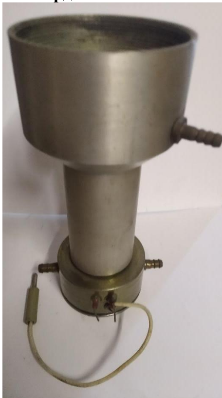
Система п'єзо-електричного вимірювання потужності лазерного випромінювання
