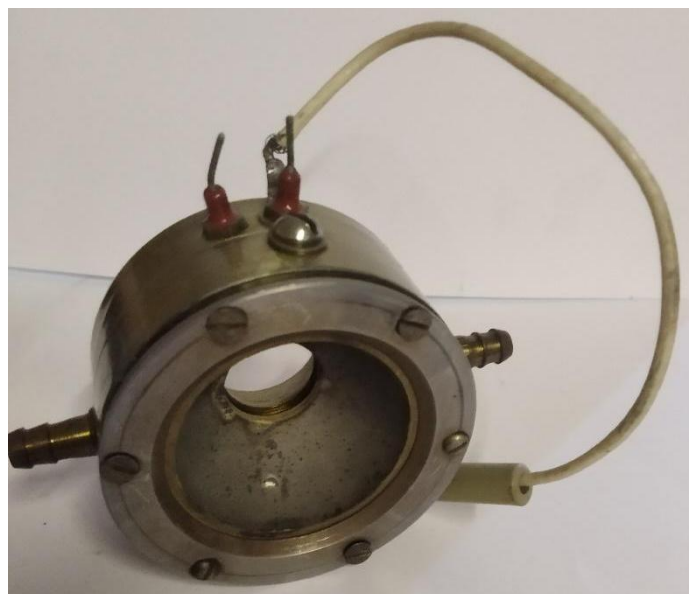
Система п'єзо-електричного вимірювання потужності лазерного випромінювання
